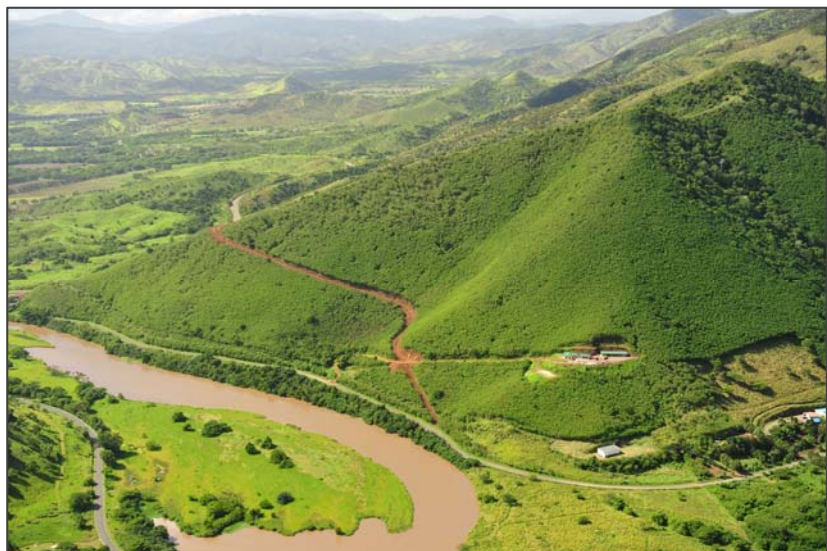
Figure 11: aménagement non adapté dans la pente avec terrassement de type déblais / remblais.
